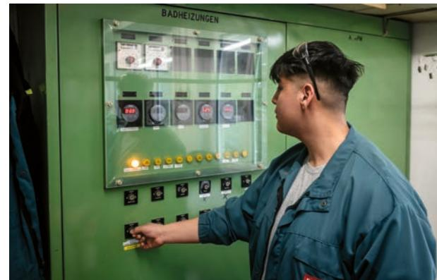
^ Maschinen einstellen Oberflächenbeschichterinnen und Oberflächenpraktiker stellen zum Beispiel die Temperatur der Bäder ein, bevor sie die Teile darin beschichten. Diese Einstellung beeinflusst das Aussehen der Metalle.
